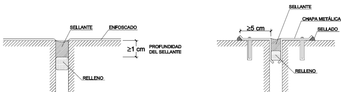
Figura 2.6 Ejemplos de juntas de dilatación
